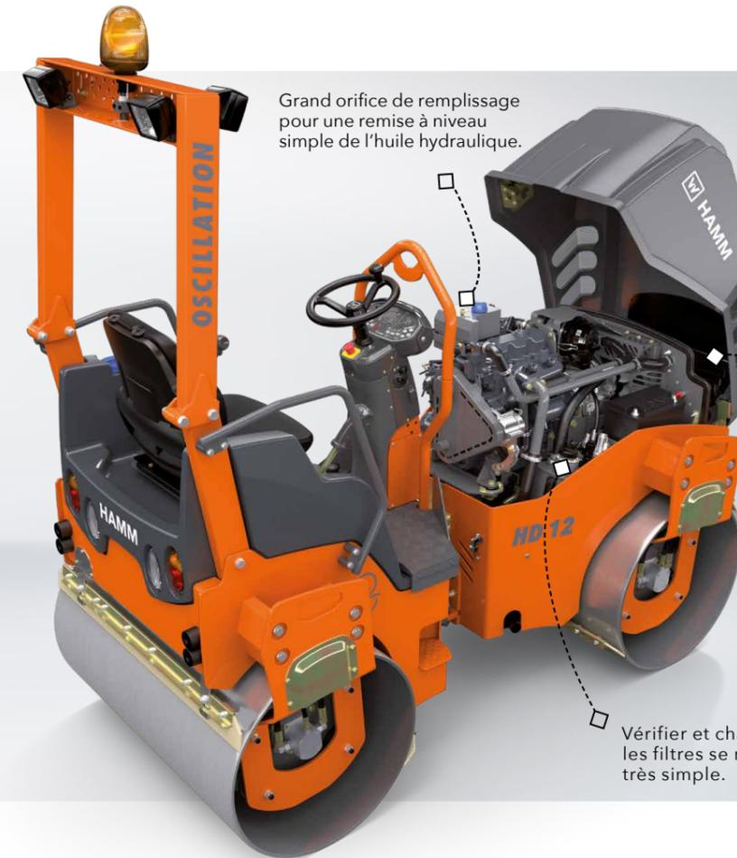
Leur entretien est extrêmement simple et rapide grâce au grand orifice de remplissage et à l'accessibilité des points de service.
