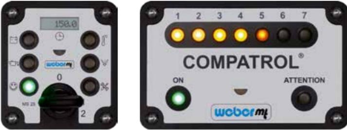
COMPATROL® 2.0 réunit deux fonctions : contrôle de compactage et gestion des données du moteur. Le contrôle de compactage permet un compactage homogène. Les zones mal compactées sont vite identifiées et peuvent être supprimées. Donc : moins de passes inutiles et de travaux de retouche. La gestion des données du moteur évite des pannes suite à un niveau d'huile insuffisant, un filtre à air encrassé ou une surchauffe du moteur.
