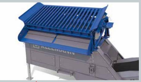
Grille vibrante<sup>+</sup> efficace, revêtement de tamis dans la partie de l'étage inférieur sélectionnable dans différentes tailles de mailles
