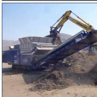
Surface de déchetage de 1,96m x 2m (6'5"X6'6") et longueur du convoyeur de 9,7m (31'10")
