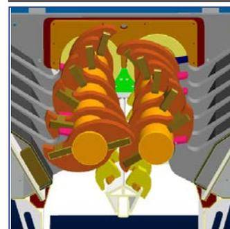
Jusqu'à 12 configurations différentes d'arbre, ce qui rend le modèle Slayer adapté à une vaste gamme d'applications.
