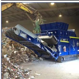
Surface de déchetage de 1,5m x 1,9m (5'X6'3") et longueur du convoyeur de 4,3m (14'1")
