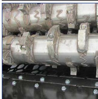
Garantie de la taille de pièce souhaitée en un seul passage. Avec un boulon sur la dent et une ouverture de maille de 50 à 250 mm.
